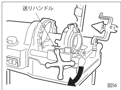
⑥ ダイヘッド持手が倣い板から落ちるとねじ切り完了です。ダイヘッド持手を手で下に押し付け、チェーザを完全に開いてください。
