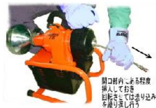
**注意:** ケーブルがチャックに正しく挟まれて回転させるには、ケーブルを送り込む際にチャックのハンドルをしっかりと押し下げてください。
