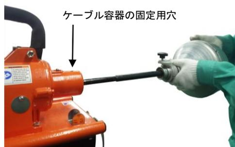
3. チャック・レバーを引き上げてバネの圧力を解放し、容器が奥まで完全にはまるようにして下さい。
