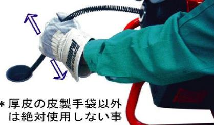
開口部のへりを利用してケーブルを回収する
