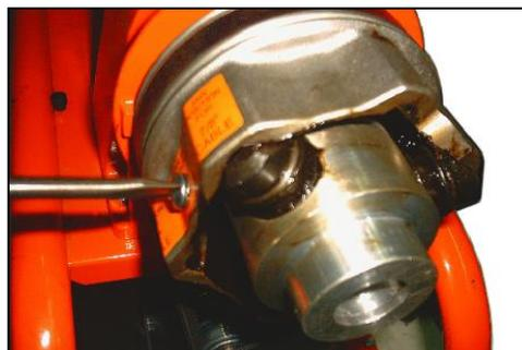
3. 3本のチャックの頭を同時に中央に押さえながらチャックハウジングを回してハウジングのきり欠き部を、一番近いチャックまでまわして行きます。
