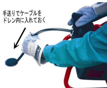
6. 電源スイッチを正転に入れてモーターを始動します。
