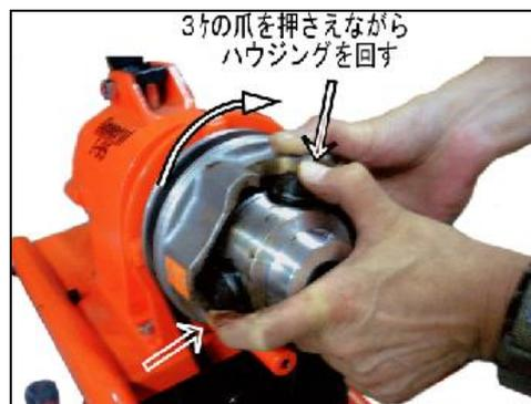
4. ひとつずつチャックハウジングをまわし、きり欠き部よりチャックを抜き取っていきます。
