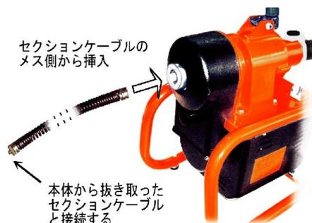
9. ケーブルが終端まで来たらそれを装置からはずしてオス型の端部を先にし、別のケーブルを装置に差し込みます。
