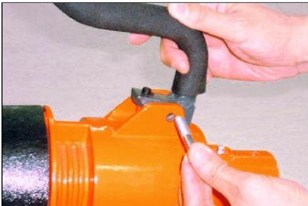
付属のクラッチハンドルを本体後方の上部にあるリブにはめ込み、付属のボルトセットを穴に挿入してナットで抜け止めする。
