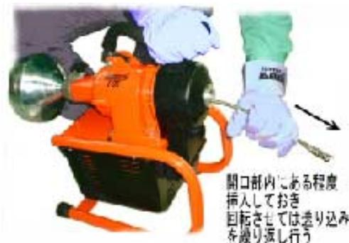
**注意：**ケーブルがチャックに正しく挟まれて回転させるには、ケーブルを送り込む際にチャックのハンドルをしっかりと押し下げて下さい。
