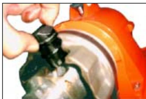
5. 組み付けは逆の手順で行い、作業が完了したら、チャックがハウジングのきり欠き部へ落ち込まないように必ずすり割り付き小ネジを取り付けて下さい。
