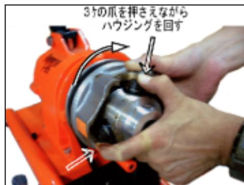
4. ひとつずつチャックハウジングをまわし、きり欠き部よりチャックを抜き取っていきます。
