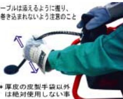
開口部のへりを利用してケーブルを回収する
