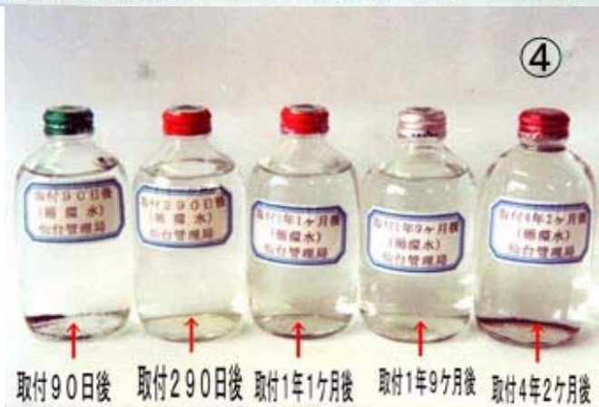
写真 処理後90日目より4年2ヶ月 のサンプリングは処理10日後 とほぼ同一の透明水で下部に 黒錆が沈殿し、同じ傾向の防食 水となつています。
