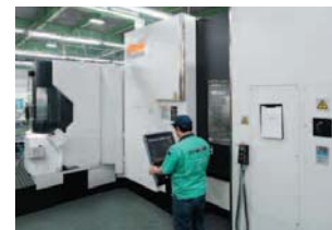
長時間無人加工可能な6パレットチェンジャ付きマザック横形マシニングセンタHCN-6000
