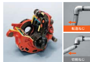
現場で容易に入替えできる、転造ねじ加工用ヘッド(左)と転造ねじ(右)の切り出し(右)の耐久試験結果。切削ねじパイプは曲げると簡単にねじ山が破壊
