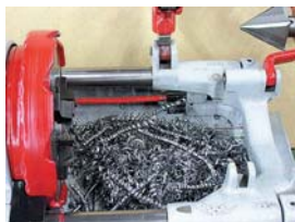
(パイプマシン切削加工)
